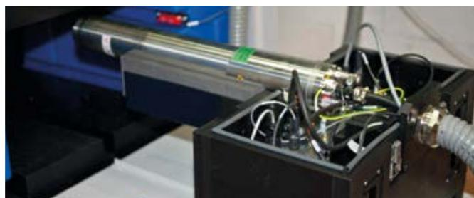
TUBE NEUTRONIQUE CIVIL DANS L'ANALYSEUR
